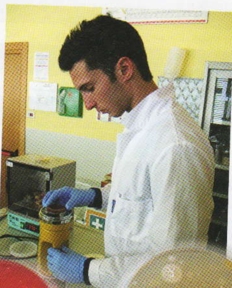
Uno degli allievi partecipanti all'indagine prepara il campionatore inserendo nella testata la contact plate sulla quale impatteranno i batteri che verranno così catturati e formeranno colonie visibili durante l'incubazione del terreno.
