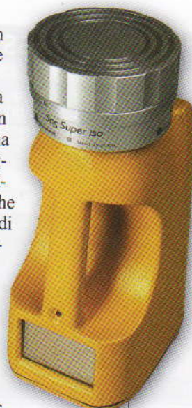
Il campionatore automatico SAS, Surface Air System utilizzato nello studio (PBI International, Milano).
