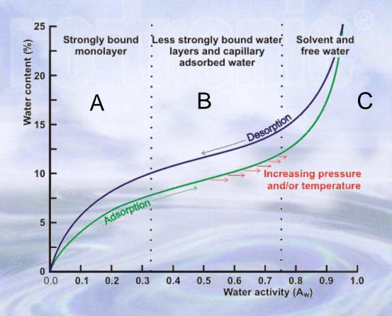
Osservando l'andamento caratteristico di una tale curva, si riconoscono tre zone principali indicate con le lettere A, B e C.
