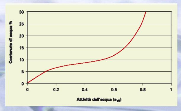
Per ogni valore di umidità relativa l'isoterma di assorbimento indica la percentuale d'acqua di un materiale ad una data temperatura costante.
