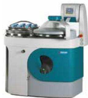
**Sterilizzatrice Serie VEGA PBI-Fedegari** con ciclo con immissione di aria e vapore in contropressione.
